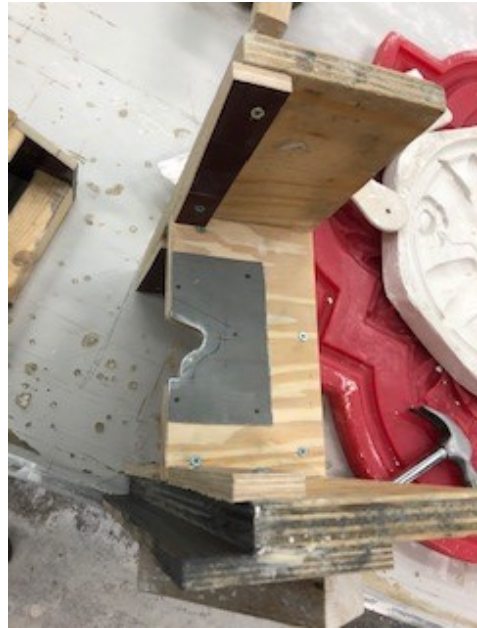
Till vänster: Den träbåge som fungerat som underlag för att motsvara tornets form. Till höger: Den släde för listdragning som använts vid nytillverkning av profilerade stucklistor. Foto: Daniel Hillman.
