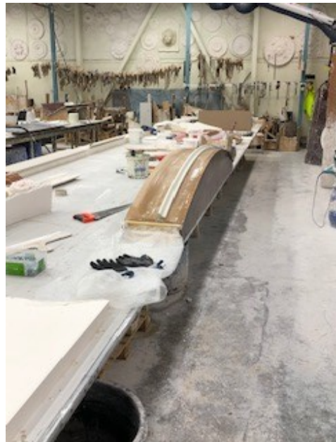
Till vänster: En stucklist dras fram. Till höger: En färdig stucklist ligger och väntar på träbågen. Foto: Daniel Hillman.
