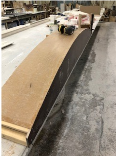
Till vänster: Den träbåge som fungerat som underlag för att motsvara tornets form. Till höger: Den släde för listdragning som använts vid nytillverkning av profilerade stucklistor. Foto: Daniel Hillman.
